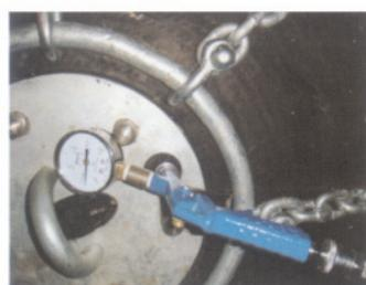
给充气阀插上快速充气配件，上拉充气阀外边缘以锁住这些配件。
