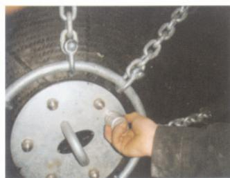
充气完毕后，使用扳手紧固外螺母。
