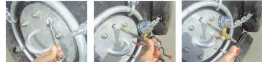
用扳手按逆时针方向拧开外部PVC螺母，用钳子拔出内部橡胶塞。
