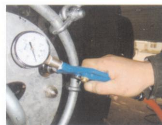
将快速充气配件与充气机连接，紧握充气触发器开始不停地充气直至内压达到0.05 - 0.08Mpa。
